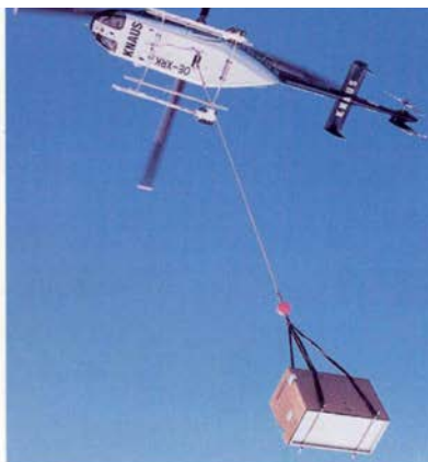
▲ Die Wärmepumpe wurde mit dem Hubschrauber zur Hütte geflogen
